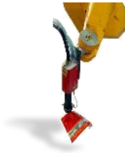
Soudage plastique robotisé
