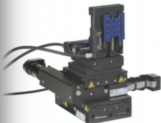
L'ensemble motorisé se distingue par sa haute précision et sa robustesse pour une utilisation en laboratoire et en environnement industriel. Tous les axes sont équipés de capteurs de position, permettant d'éviter les collisions avec les composants en cours de test.
