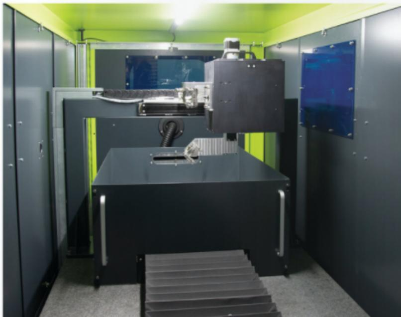
les vitesses de traitement spécifiées, Alphanov a acquis un laser Tangor 350 W de la société Amplitude Systèmes. Le Tangor peut délivrer jusqu'à 350 W de puissance moyenne à très haute cadence (13 MHz de taux de répétition maximum) et avec des durées d'impulsion de 500 femtosecondes. Ce laser a une longueur d'onde dans l'infrarouge de 1 030 nm.
