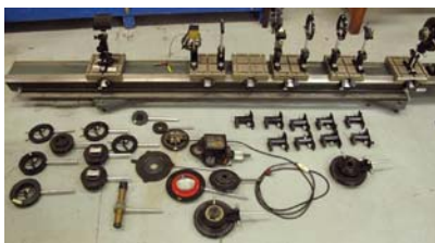
Banc d'étude 2485 mm, + 25 composants opto-mécaniques : agilité et stabilité !
