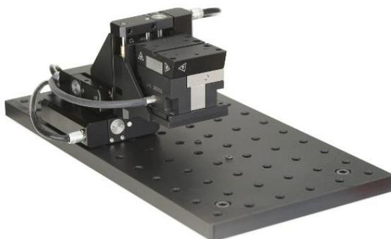
La configuration XYZ de ce nouveau système d'alignement se compose de trois étages linéaires motorisés de la série M-111 et d'une platine piézo 3 axes fonctionnant en boucle fermée. Ce système 3 axes permet de réaliser les fonctions de scan et d'assurer une longue durée de vie au système.
