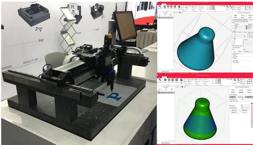
En combinaison avec des axes motorisés haute performance, PI propose un logiciel d'interface puissant, dédié aux systèmes d'impression 3D et fonctionnant directement à partir de fichiers STL. Ce programme s'appuie sur le logiciel Smart Processing Commander (SPC) compatible avec les contrôleurs ACS Motion Control.
