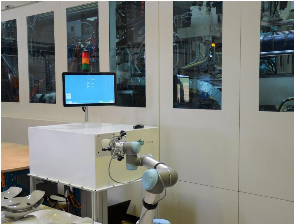
Système Teratronics STRIPP Control - ici mis en œuvre sur une machine de moulage par injection pour le contrôle des pièces en plastique, immédiatement après leur fabrication.
