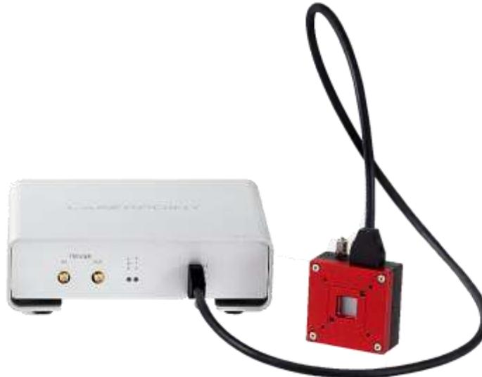
Ce système assure une surveillance totale en temps réel, capable de détecter toute impulsion manquante lorsque l'énergie est insuffisante pour déclencher le compteur HSM. Il permet également un contrôle qualité avancé en identifiant chaque impulsion dont l'énergie est inférieure au seuil défini par l'utilisateur. Basé sur la technologie éprouvée des capteurs thermiques Blink High Speed, associés au High Speed Meter, il garantit un suivi dynamique et continu du faisceau laser.
