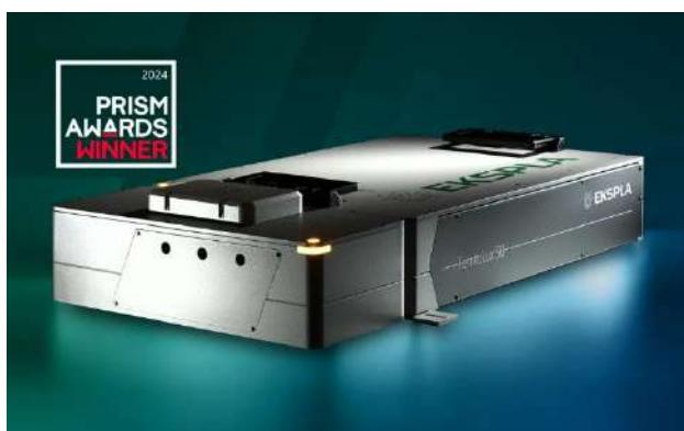
La série FemtoLux, intégrant le refroidissement DRC, cible les environnements industriels intensifs : micromachinerie de précision, découpe de stents, fabrication de semi-conducteurs et lignes de production continues.
